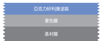
■亞克力矽利康塗裝的結構剖面圖(示意圖)
