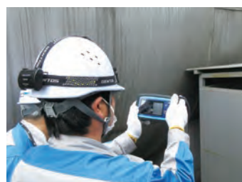
蒸気漏れチェック (伊賀事業所)
