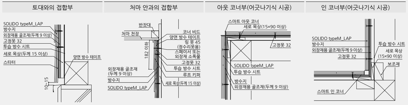
※기타 맞춤 아웃 코너 장착 등에 대해서는 「LAP-WALL/SOLIDO typeM\_LAP 설계 시공 매뉴얼」을 참조해 주십시오.
