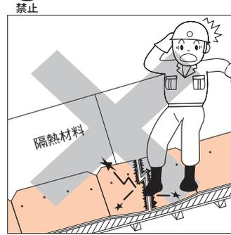
在缺乏剛性的底材上施工，會導致出現屋瓦被踩裂的情況。
