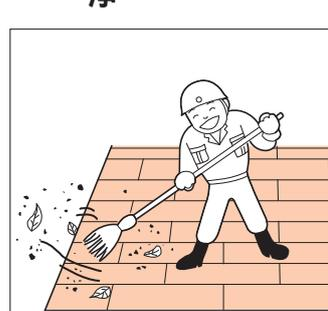
若將作業過程中製造的垃圾、裁切材料時的粉塵及碎屑置之不理，這些汙物會侵入屋瓦的間隙，導致發生漏雨及材料破損等情況，請務必將屋頂面清理乾淨。請注意避免試圖以溼布或刷子拭除屋瓦表面附著的粉塵，否則可能會使粉塵受到重壓，反而變得難以清除。
