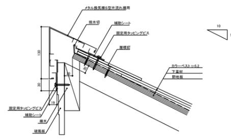
片流れ棟用S型(破風後付け) 仕様
