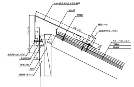
12 片流れ棟用S型 防火ダンパー(破風後付け) 仕様
