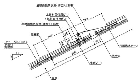
グランネクスト/カラーベスト 5.2mm厚品 / 木造 参考納まり図【換気役物】
