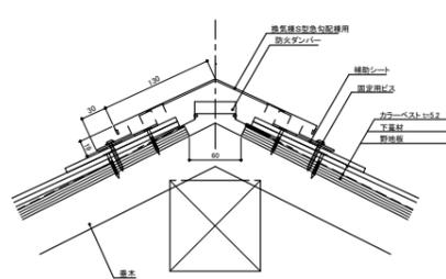
10 片流れ棟用S型(破風先付け) 仕様
