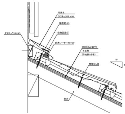
2 桁方向(最上段切断)仕様
