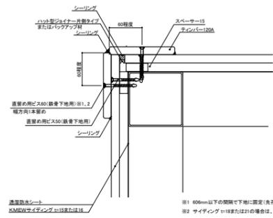
※1 600mm以下の間隔で下地に固定(先孔不要)、パテ埋め後、現場仕上がり塗料で補修
