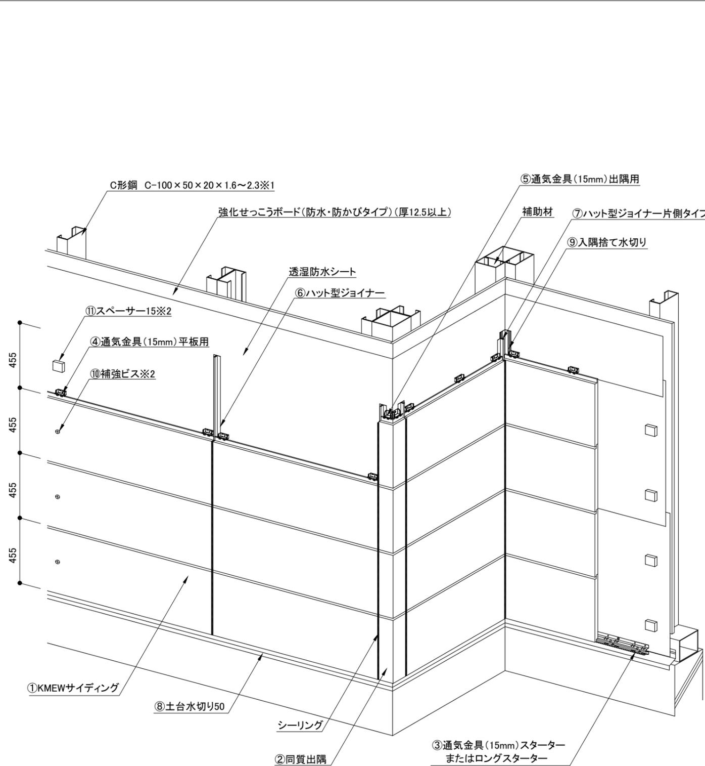
※1 防火構造認定PC030NE-3915(1)又は(2)では、下地(C形鋼)の間隔が910mm以下となります。
