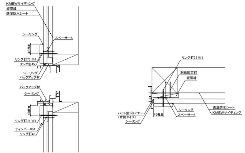
※1 先孔(φ2.8)を600mm以下の間隔であけてから下地に固定
