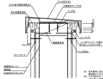
※1 笠木部材に当たらないよう、縦筋線は笠木下地上面から50mm程度高さを確保する。
