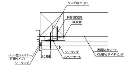
※1 先孔(φ2.8)を600mm以下の間隔であけてから下地に固定
