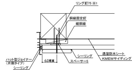
※1 先孔(φ2.8)を600mm以下の間隔であけてから下地に固定
