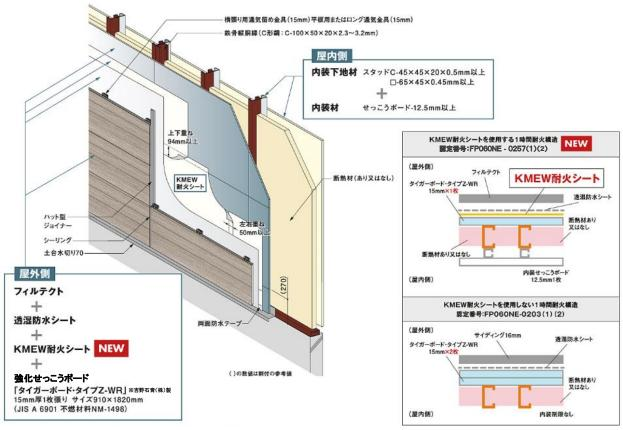
今回国土交通大臣認定を取得した鉄骨造外壁一時間耐火構造は、耐火シートを使用した業界初の外壁耐火構造認定です。新たに発売した「KMEW 耐火シート」は、働き寸法がせっこうボードと同じながら、非常に軽量な仕様となっています(強化せっこうボード 19.4 kg→KMEW 耐火シート 1.6 kg)。この耐火シートを使用することで、屋外側のせっこうボードを従来認定では 2 枚張りのところを、新認定では 1 枚張りに抑えることができるので、省施工となり工期短縮が期待できます。さらに、耐火シートには重なり位置を示す補助線を施しており、一層の施工性向上を図っています。
