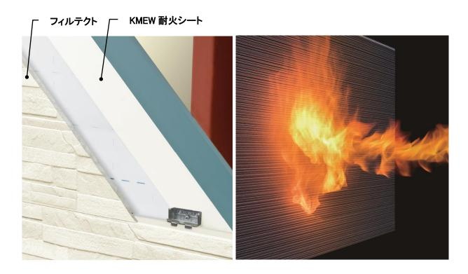
火災の熱で発泡し、熱の伝達を抑えます。
