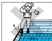
太陽光パネル設置中および設置後の屋根材端部への歩行は十分にご注意ください。ケイミー屋根材の踏み割れの原因になります。
