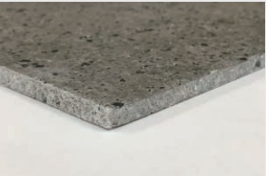
製品表面と小口面の色差の例 (9)
